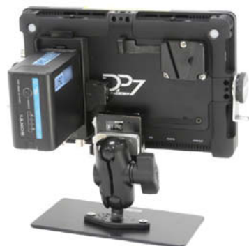
各種受信機を取り付けられるVマウントホルダー装備 U60バッテリーホルダーからDタップより電源供給可能
