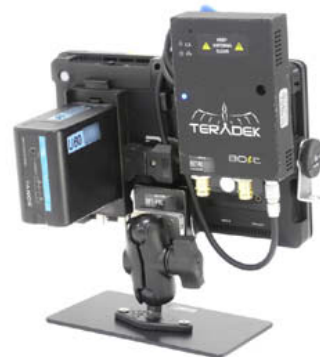
BOLT受信機 取り付け例 U60バッテリーで約2時間使用可能
