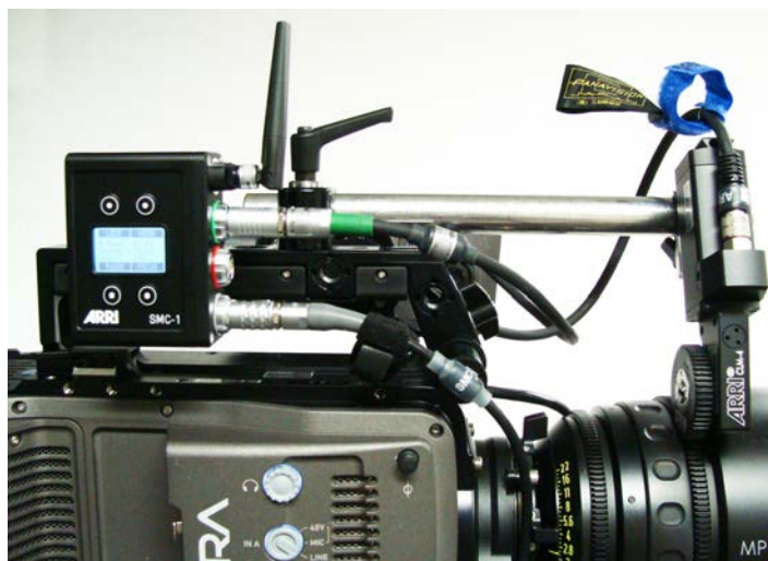
取り付け例(AMIRA カメラ) SMC-1 + RMB(三和製) + 19 ロッド + CLM-4 モーター
