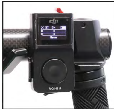
手元のサムコントロールで、オペレーターがパン軸とチルト軸を直接調整できます
